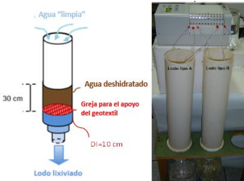
Figura 6.5 Esquema y foto del ensayo de lixiviación de los lodos tipos A y B
