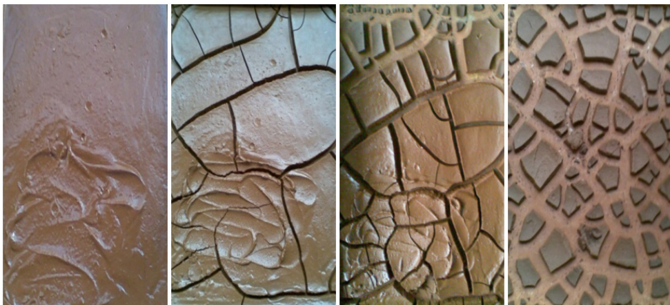
Figura 6.2 Transformación del lodo de PTAP del estado líquido a sólido.
