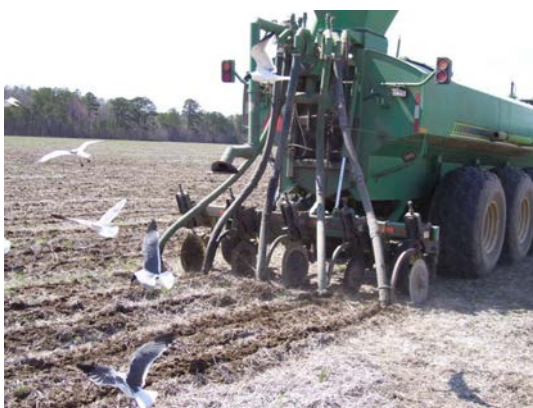
Figura 6.7 Aplicación de lodo de las PTAP con contenido de sólidos de 2 a 4% en suelo.
